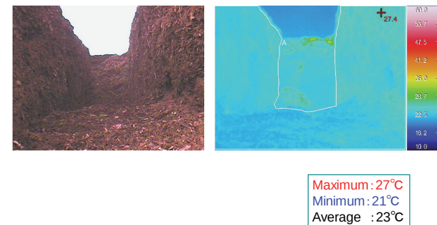
図-6 E-1 地点サーモグラフィ画像（掘削 18 時間後）
