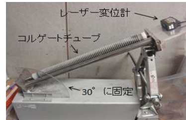
写真-1 長さ変化測定装置
