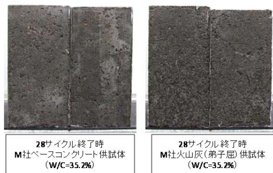
写真-2 スケーリング試験終了時（M 社）
