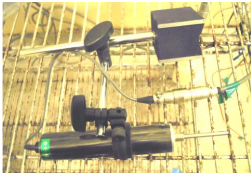
写真-2 低温室内の変位計の値の測定の様子
