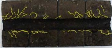
写真-4 曝露供試体表面 (わだち掘れ作製後)
