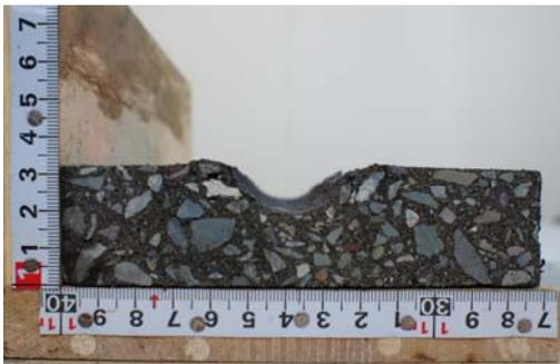
写真-5 新材断面 (わだち掘れ作製後)
