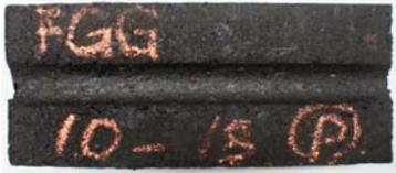
写真-3 新材表面 (わだち掘れ作製後)
