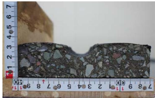
写真-6 曝露供試体断面 (わだち掘れ作製後)
