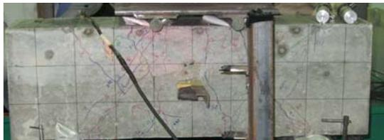
写真-1 反転載荷後供試体状況
