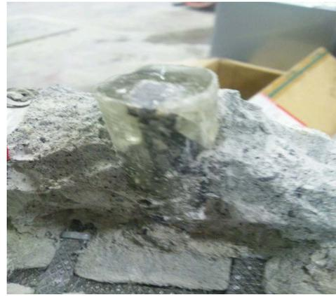
写真1 アンカー筋の抜け出し (供試体 EA8)
