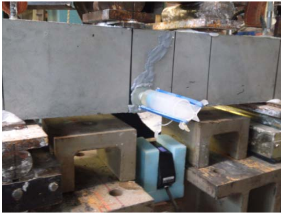
写真1 ひび割れ注入補修の様子
