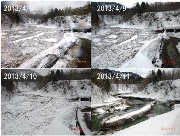
写真-3 河氷の集中流下と滞留、閉塞、解氷までの取水口の様子
