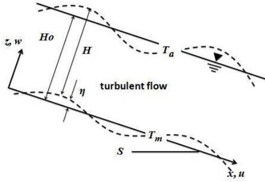
図2 流れと座標系の概念図
