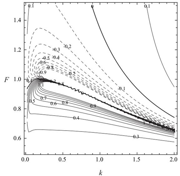
図4 擾乱の増幅率  $Im[\omega]$  のコンタ - 図 .  $Re=10000, T_a=1, Pr=7$
