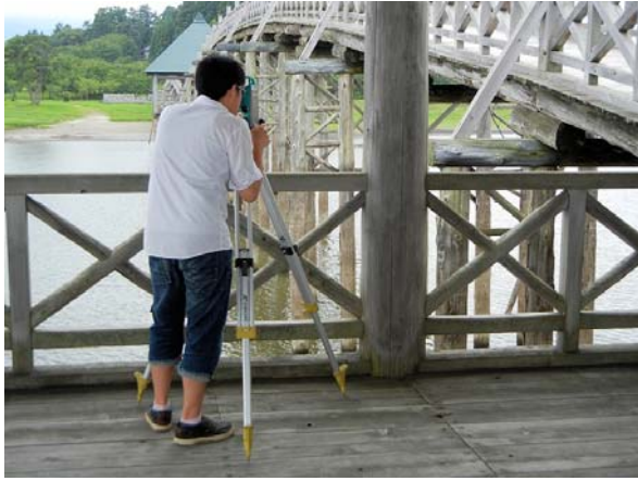
写真-3 トータルステーションによる測定
