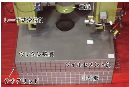
写真-3 実験状況 (S100-U)
