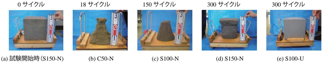
写真-2 凍結融解試験後の状況写真
