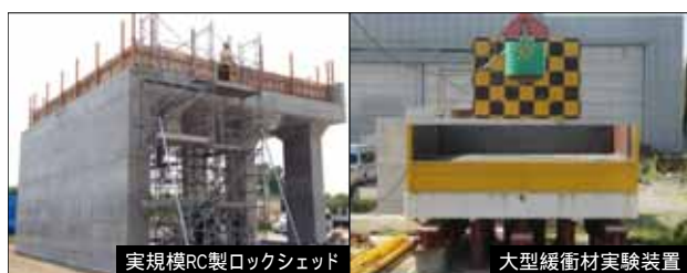
図-1 供試体；(左側)：実規模 RC 製ロックシェッド， (右側)：大型緩衝材実験装置
