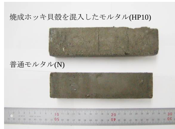
写真-1 膨張した供試体(40×40×160 mm) 1)
