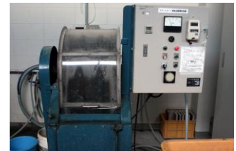
図-2 スチールロッド式摩耗試験機の模式図・写真
