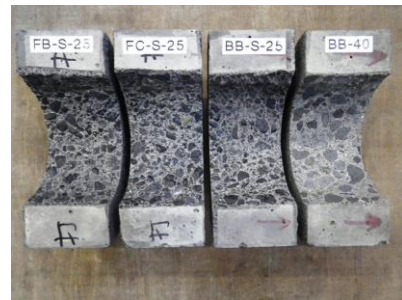
写真-2 掃流式摩耗試験供試体(磨耗面)の状況 (左側から FB-S-25, FC-S-25, BB-S-25, BB-40)
