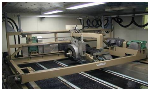
写真-1 室内凍結路面走行試験装置
