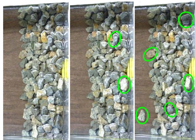
写真-3 マウンド材の移動状況
