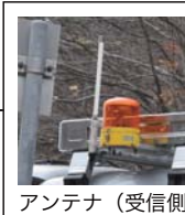
アンテナ（受信側）
