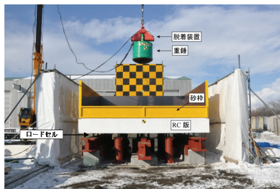
写真-1 実験装置および重錘
