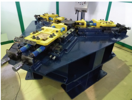
写真-2 せん断疲労試験機の全景
