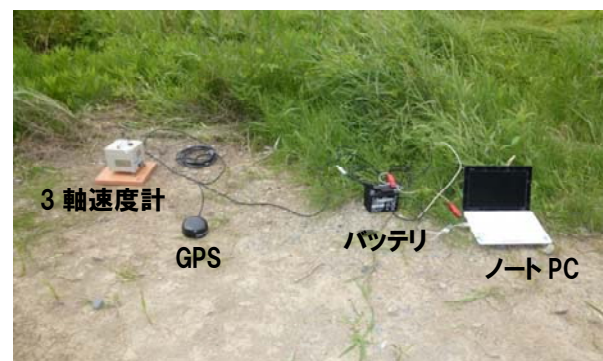
図-1 常時微動の測定状況
