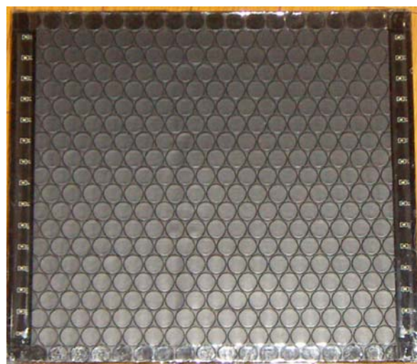
写真-3 避難誘導（圧電素子）LED マット
