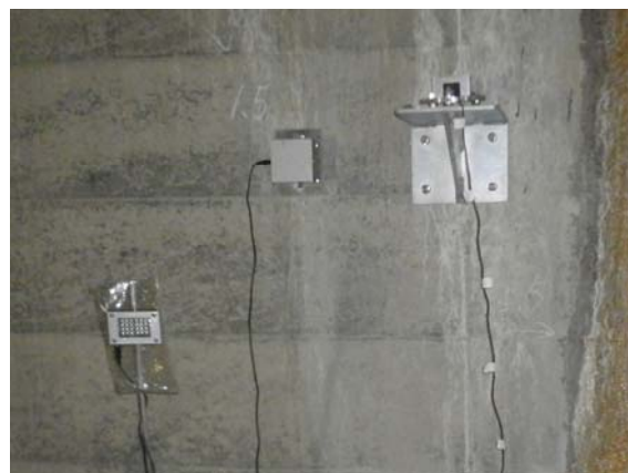
写真-1 簡易振動計（トンネルの発破振動観測）
