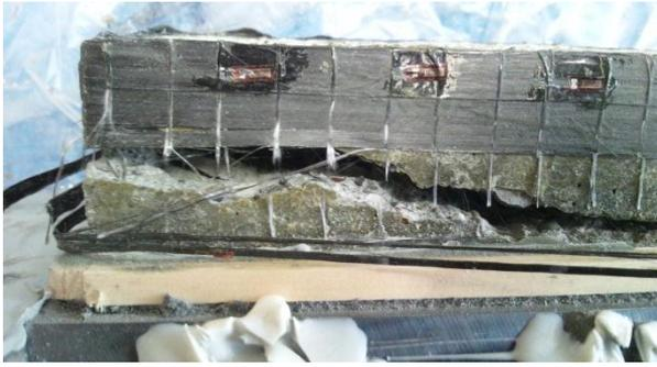
写真-5 M8-2 破壊状況(破壊モードC)
