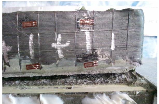
写真-4 M5-2 破壊状況(破壊モードB)
