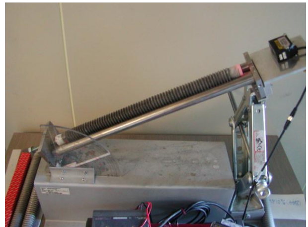
写真-2 長さ変化測定装置
