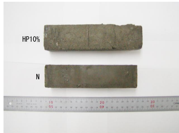
写真-1 膨張した角柱供試体のモルタル
