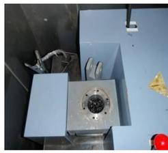
写真-6 一面せん断試験機(左), 供試体の設置状況(右)
