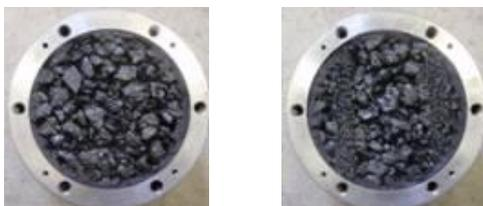
写真-2 排水性舗装(左)、排水性-G(右)
