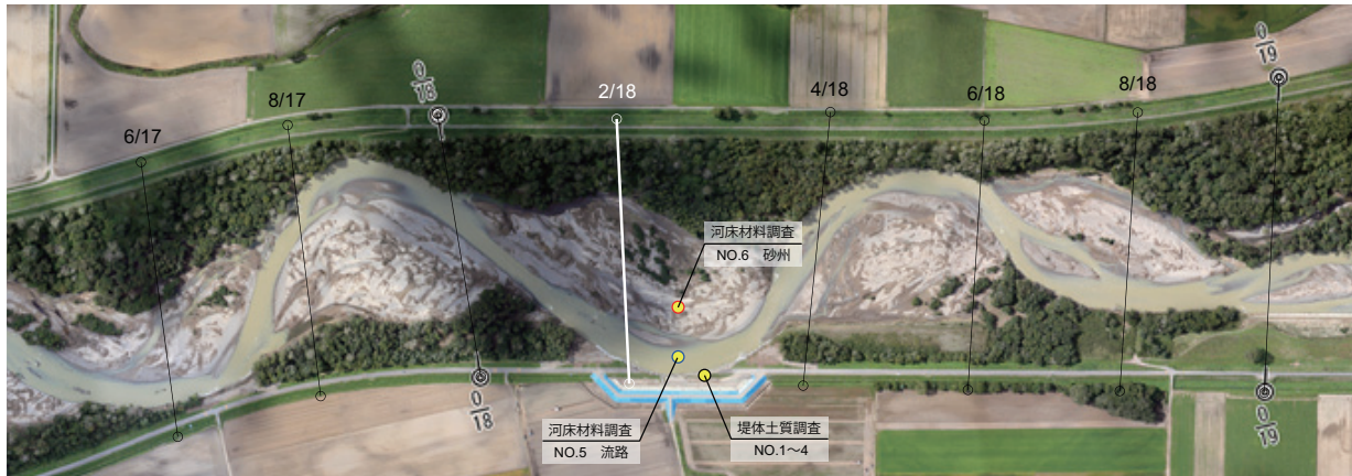
図-3 堤体土質調査及び河床材料調査の実施箇所（平成23年9月26・27日，堤防流出箇所周辺）
