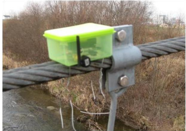
写真-1 外付けアンテナ用センサー設置方法
