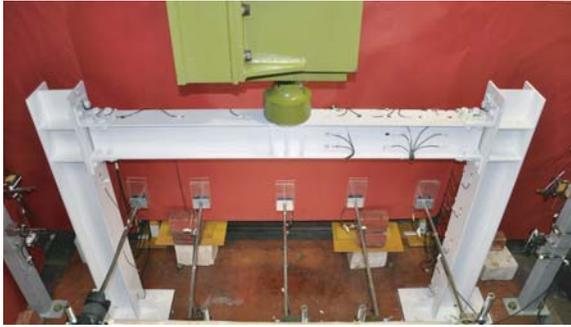
写真-1 衝撃実験状況
