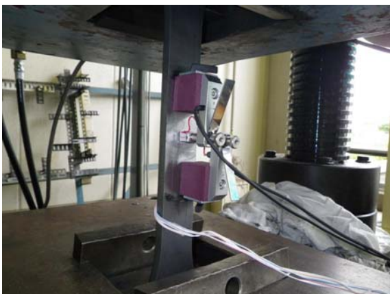
図-6 センサーの設置状況
