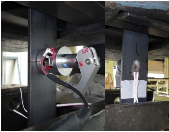
(a) 従来型応力聴診器 (b) ひずみゲージ 図-4 センサーの設置状況
