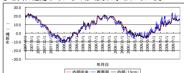
図-4 コンクリートの温度解析結果(2年間)
