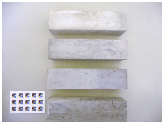
図-3 作成した供試体（上から 0.0, 0.1, 0.2, 0.3 vol%）
