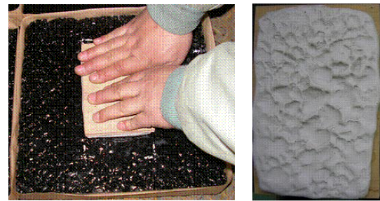
写真-6 パテを用いたMPD測定の様子(左)と舗装に押し付けた後のパテの様子(右)
