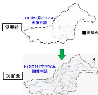
図-2 額平川流域の H15 豪雨前後の崩壊地判読結果 1) (黒色が崩壊地)
