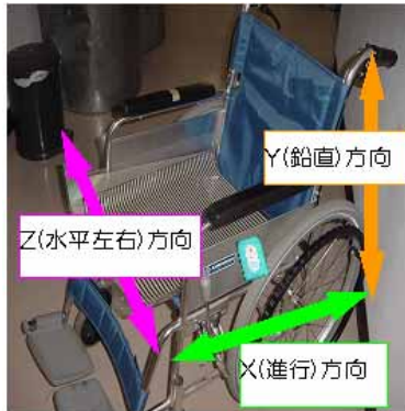
図－1 加速度測定器測定方向
