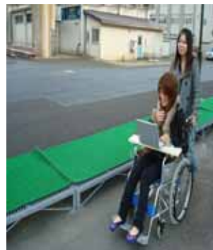
図-11. 非透水性舗装 の走行実験風景
