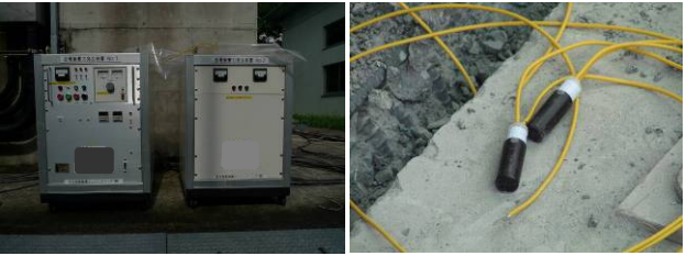
写真 3.1 直流高圧電源装置 写真 3.2 カートリッジ
