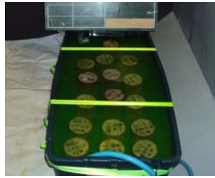
写真5 供試体の浸漬状況
