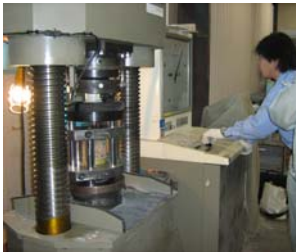
写真4 一軸引張試験状況
