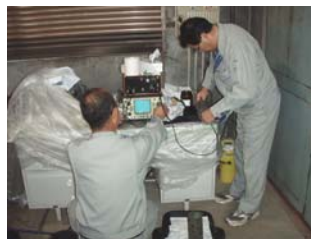
写真9 超音波伝播時間測定
