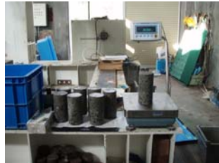
写真7 供試体重量測定
