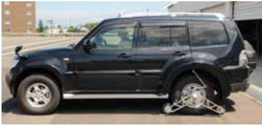
図3 従来型測定装置の設置状況
