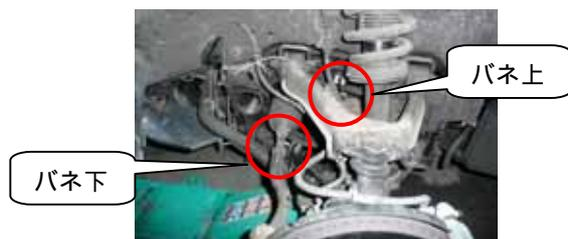
図1 加速度計設置状況
