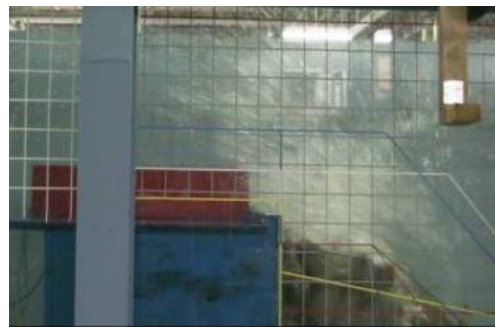
写真-2 越波水塊の飛散状況
