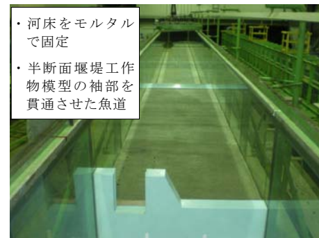
写真-3 模型実験水路の様子（固定床）
