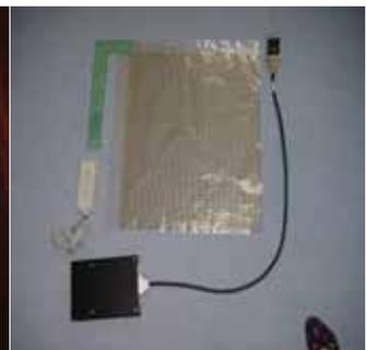
写真-3 圧力測定器
