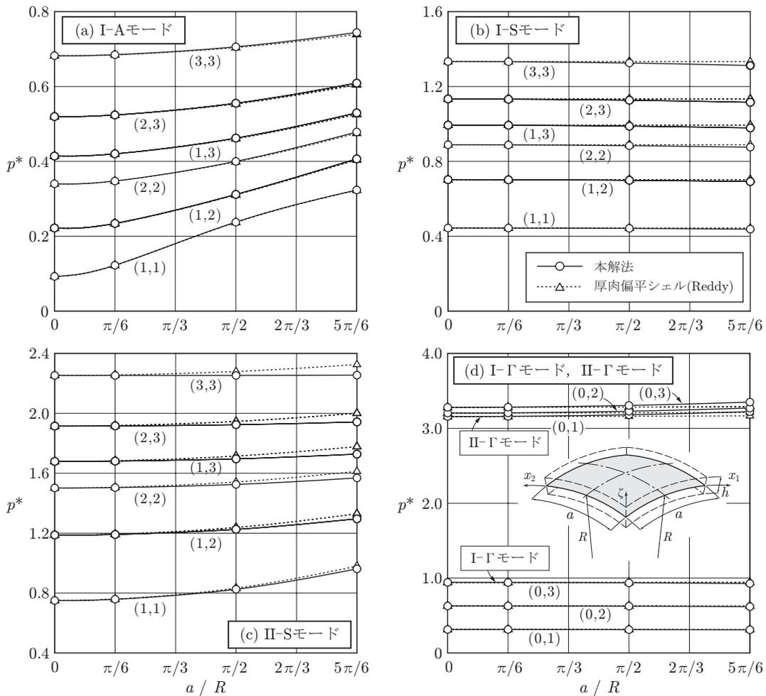
図-5 球形シェルの固有振動数 (曲率  $a/R=0 \sim 5\pi/6$ )
