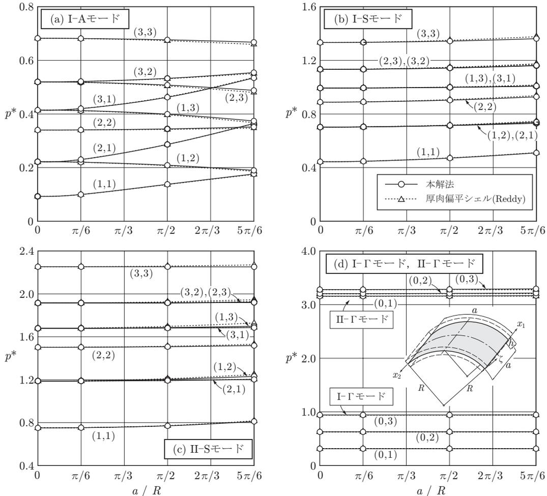
図-4 円筒シェルの固有振動数 (曲率  $a/R=0 \sim 5\pi/6$ )
