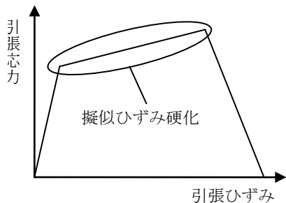
図-1 ECC の応力-ひずみ関係模式図
