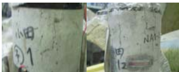
写真-2 水中圧縮試験(左) 気中圧縮試験(右)
