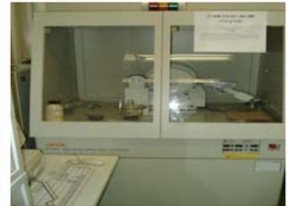
図-8 粉末 X 線回折装置
