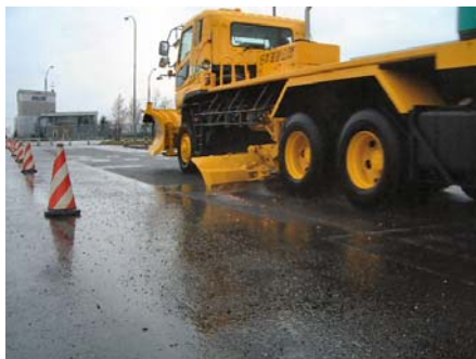
写真-6 除雪車を用いた耐摩耗試験
