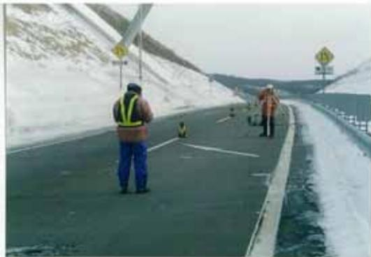
写真 - 1 凍上測量状況
