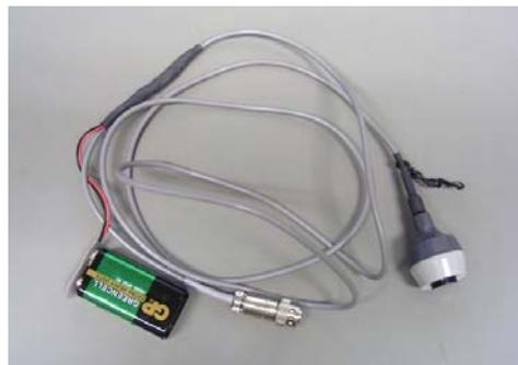
写真-2 使用した乗り心地評価スイッチ (加速度・GPS ログと同期させる)
