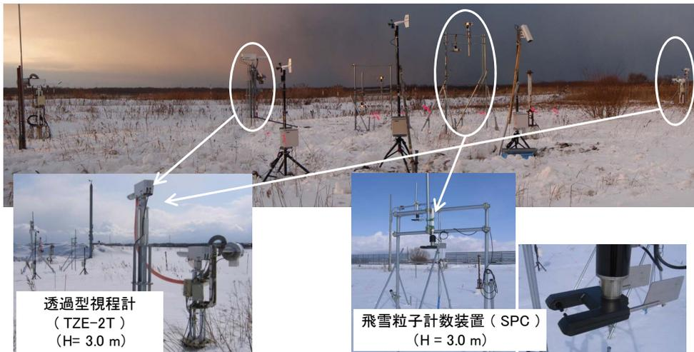
図5 気象観測機器の設置状況(透過型視程計1台、飛雪粒子計数装置1台)
