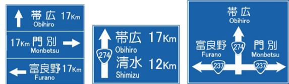
方面、方向及び距離 (105系) 方面及び距離 (106系) 方面及び方向(の予告)(108系)
